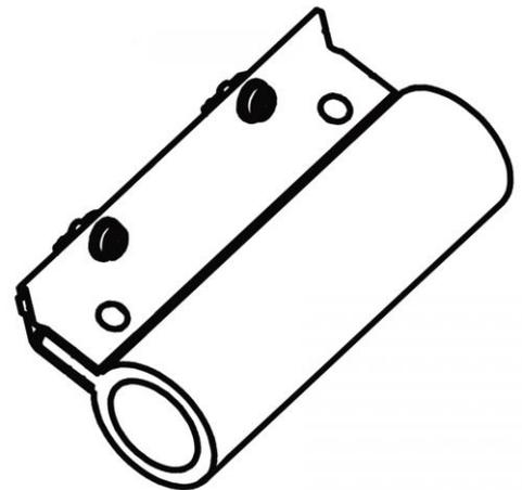
Stoßschutz zur Anbringung an Plattform, Stütze oder Fahrtraverse.
