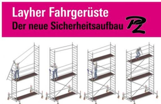
**Die Nachrüstung eines vorhandenen Fahrgerüsts Uni Leicht auf die Bauform P2 ist mit Standardeinzelteilen des Gerüstbaukasens in bewährter Layher Qualität möglich**
