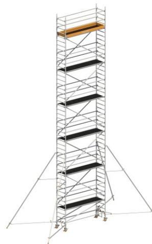
**Gewicht:** 494.4 kg**Plattformbreite:** 0,75 m**Plattformlänge:** 2,85 m**Kategorie:** Rollgerüst**Gerüsthöhe:** 12,43 m**Standhöhe:** 11,20 m**Material:** Aluminium**Arbeitshöhe:** 13,20 m**gpsr\_manufacturer\_city:**
